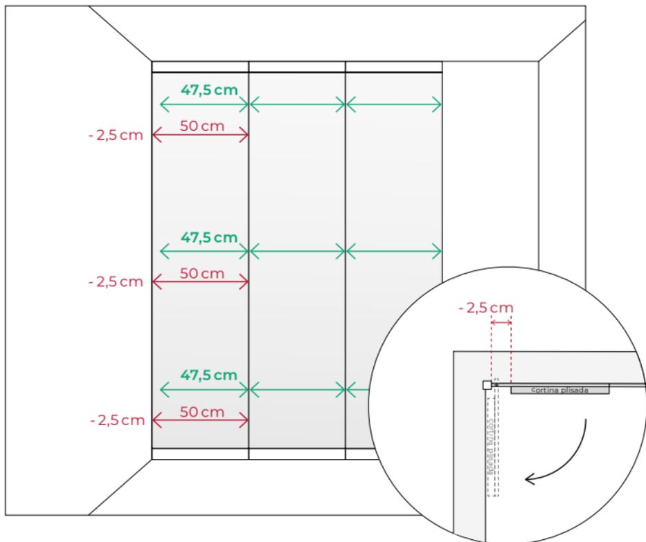
Si la hoja junto a la pared es móvil y no tiene juntas de goma, restamos 2,5cm en el lado de la pared para evitar que choque al abrirse.
