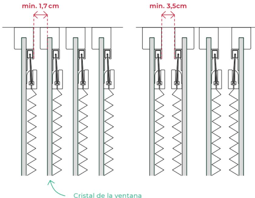
Abrimos las hojas por completo y verificamos que entre hoja y hoja queda un espacio de al menos 1,7 cm para que el sistema entre y permita la apertura total de las hojas. Si la instalación de la cortina debe ser una enfrente de la otra debido al tipo de apertura de las hojas, entonces debe haber un espacio de al menos 3,5 cm entre ellas.
